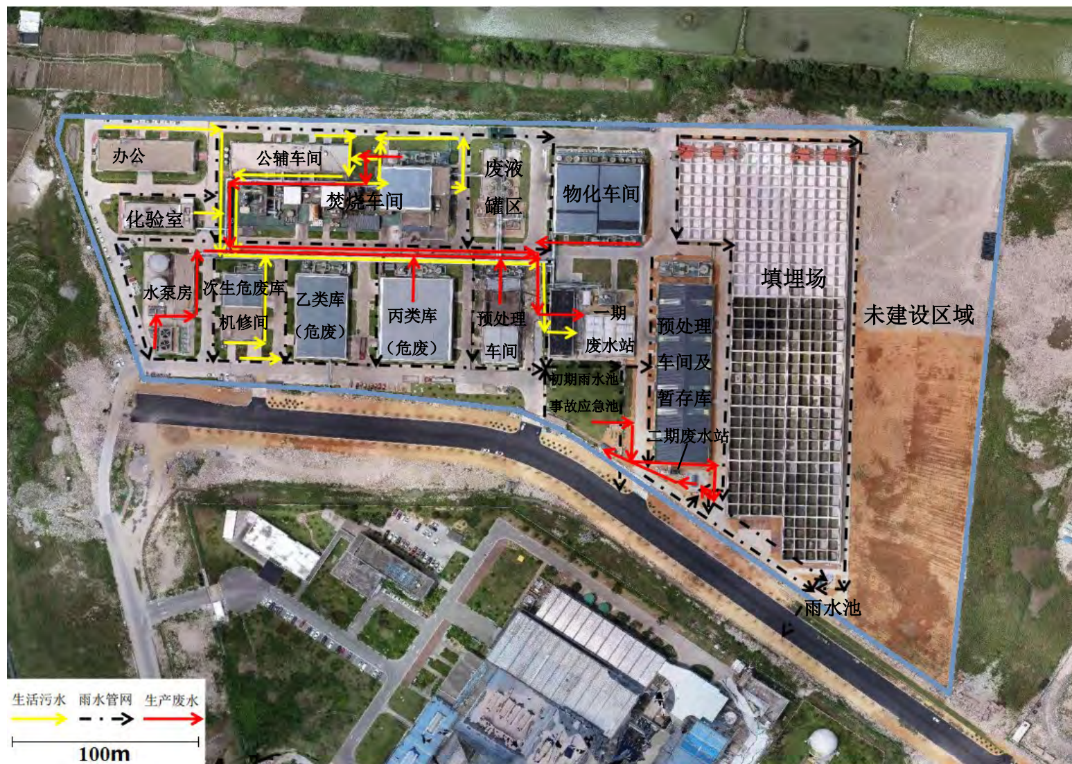
图 4.2-1 企业用地平面布置图（含雨污管网）
